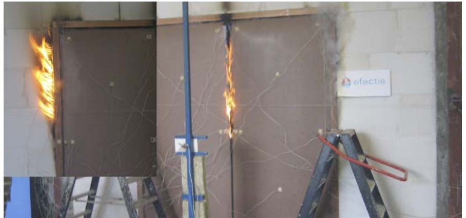
Figuur 32: Einde brandproef van een houten dubbele deur na 37 minuten.
