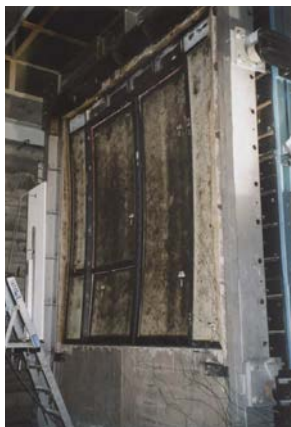
Brandproef van een schuifpui 3,2 m hoogte met brandwerend glas (het brandwerende glas is reeds opgeschuimd).
