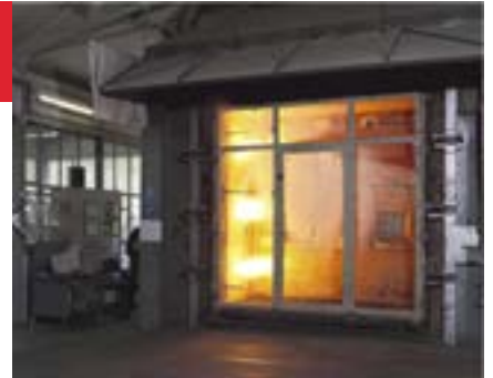
Start brandproef van een enkele deur met twee zijlichten en een bovenlicht.
